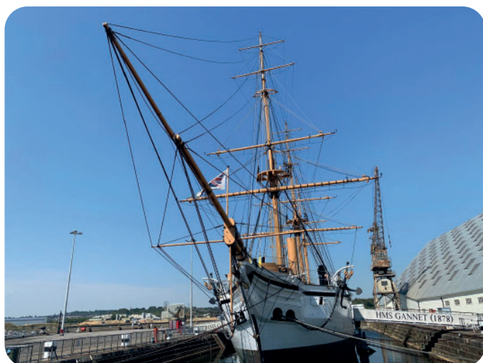
HMS GANNET, net zoals de CUTTY SARK een houten zeilschip gebouwd op stalen spanten.
